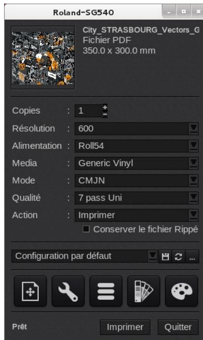
Veuillez noter que même si des profils génériques sont fournis dans le driver avec la version "WithProfiles", il est recommandé de créer vos propres profiles pour vos médias spécifiques et ce pour une qualité d'impression optimale.
